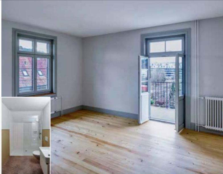
Die vorhandenen Alterswohnungen wurden umgebaut. Dabei belies man die Raumstrukturen der Drei- und Vierzimmerwohnungen, machte sie aber barrierefrei. So sind die vergrösserten Balkone schwellenfrei zugänglich, die Bäder wurden mit bodenebenen Duschen ausgestattet.
